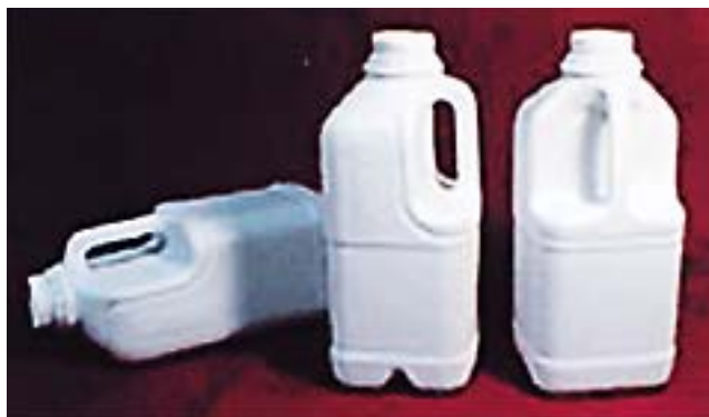
40%比重軽減のMuCell 微細発泡 HDPE ブローボトル
