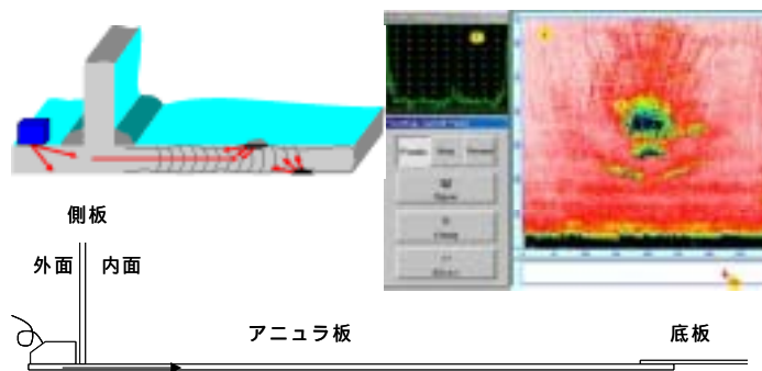
図9 長距離超音波探傷装置の外観写真及び探傷結果出力例
